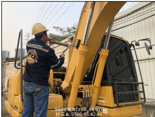
ภาพที่ 23 กิจกรรมการใช้น้ำมันหล่อลื่นเครื่องจักร
